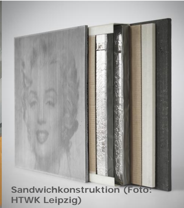
3 cm dünnes Fassadenelement aus Textilbeton (Foto: Ulrich van Stipriaan)
