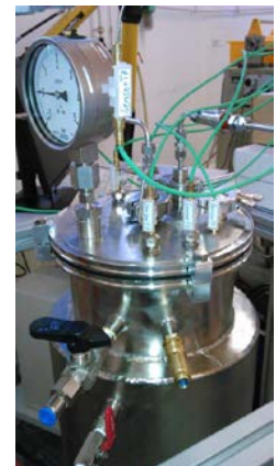
Versuchsanlage Zeolith - Wärmespeicherung
